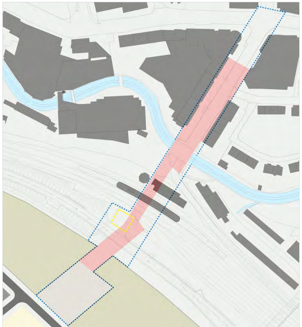
Abb. 2: Projektierungsperimeter (rot), Abbruch Cementweg 18 (gelb), Betrachtungsperimeter (blau)
